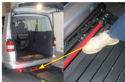
Sistema anti aplastamiento del pie con sensor por desconexión de la alimentación
