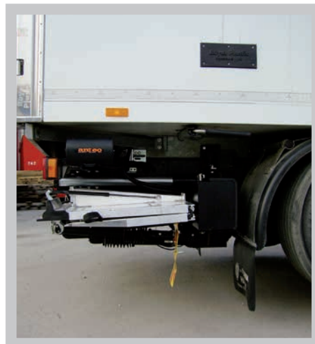
Montaje lateral para máquinas motrices - Plato 2 plegados
