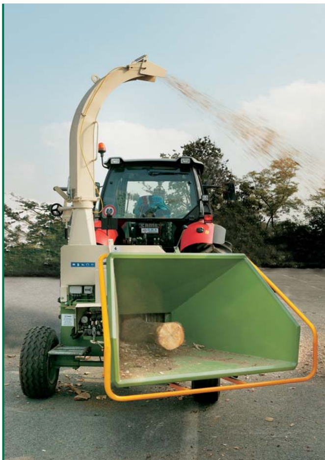
La astilladora H880/250 puede astillar troncos hasta 25 cm de diámetro.
