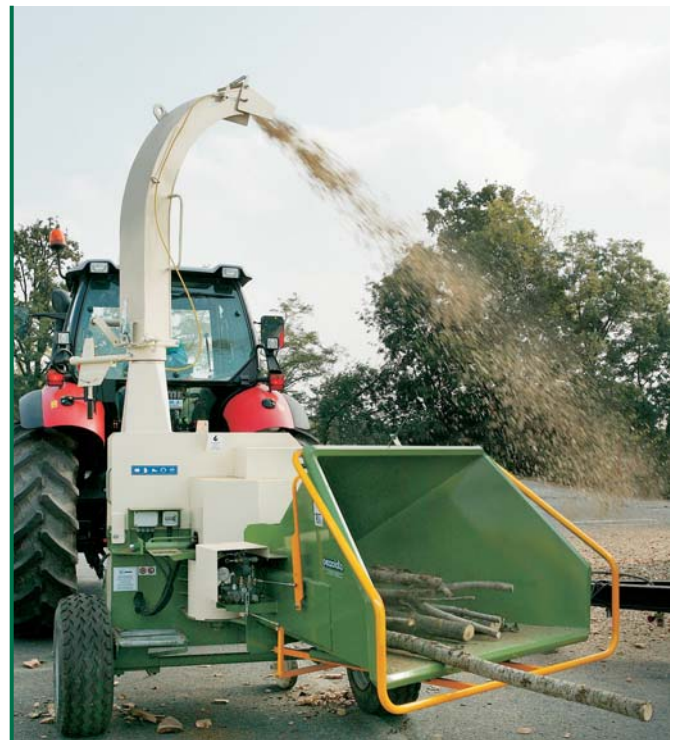
La astilladora H 880/250 al trabajo con pequeños troncos y ramas.
