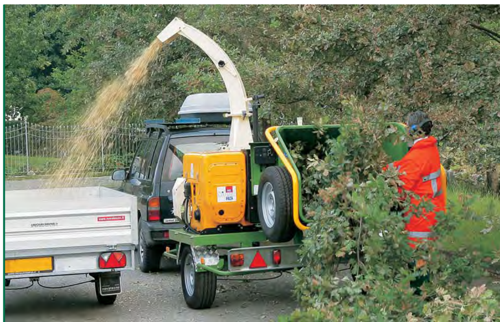
La versión PZ 190 M en acción. Funciona con motor Diesel HATZ de 52 Hp, silenciado, y está montada en carro para arrastre a 80 km/h. También esta máquina – a pedido – puede montarse en carro "tándem" con pivote giratorio.
