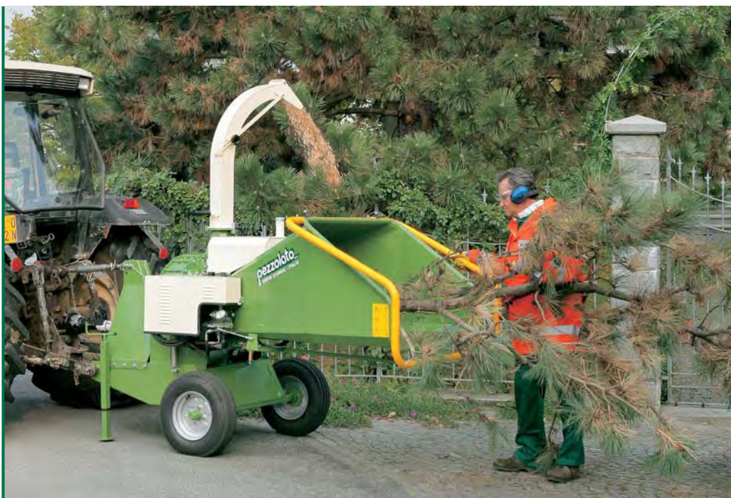
La versión PZ 140 G en acción, funciona con la toma de fuerza; está dotada de serie con enganche para el tercer punto del tractor y ruedas revestidas de caucho para facilitar su almacenamiento. Aplicando el timón desmontable, la máquina puede también ser arrastrada a baja velocidad.
