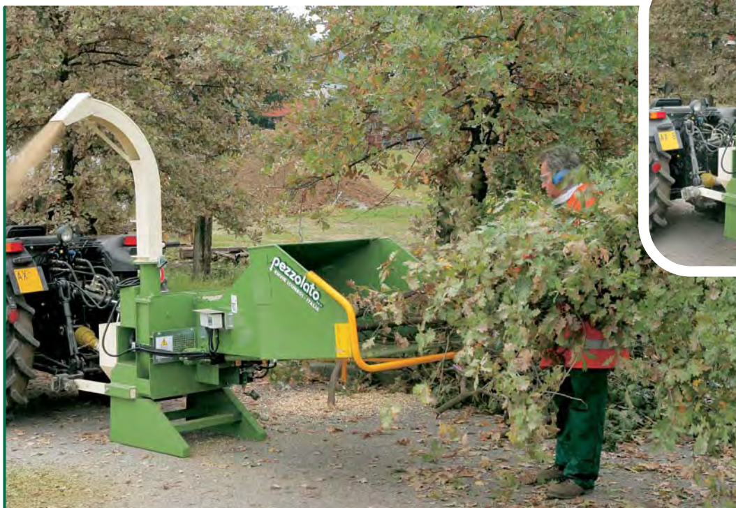
La versión PZ 110 G en acción, funciona con la toma de fuerza y está dotada de enganche para el tercer punto del tractor. En el detalle, la máquina está compactada en posición de viaje.
